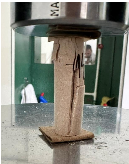
Слика 7. Компресиона чврстоћа
