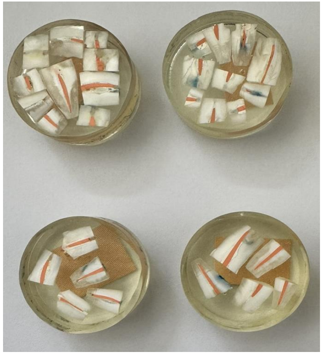
Слика 18. Узорци заливени смолом
